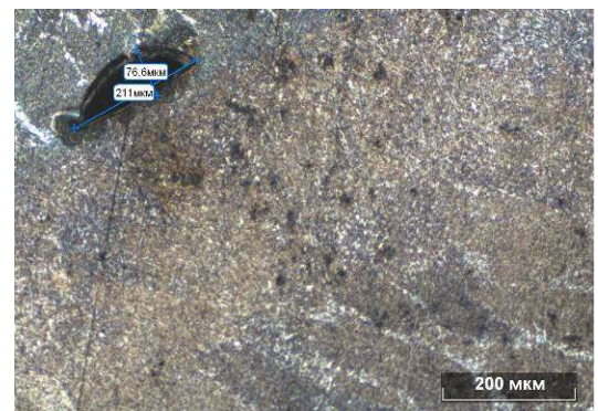
б) параметры дефекта 15.2 на глубине 8,61 мм
