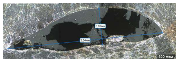
б) параметры дефекта 1_2 на глубине 1,66 мм
