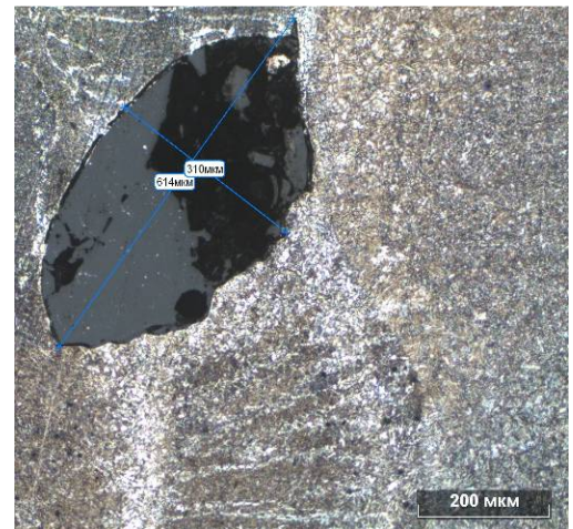
а) параметры дефекта 15_1 на глубине 7,61 мм
