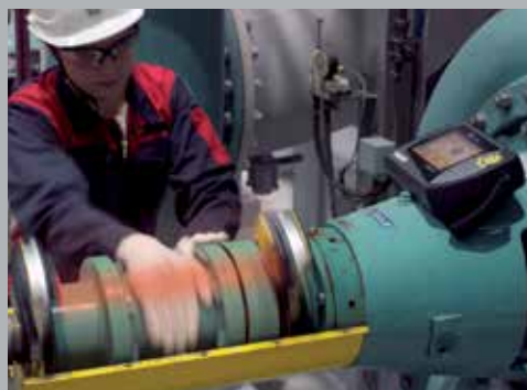
Проведение измерений Система осуществляет сбор и анализ сотен показаний и передаёт их по беспроводной связи на компьютер.
