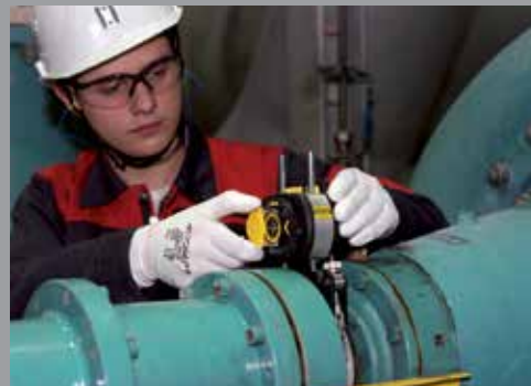
Монтаж Датчик и лазерный излучатель монтируются на вал при помощи компактного цепного или магнитного крепления.
