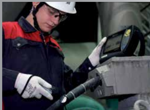
Сохранение Обновленная информация по оборудованию и состоянию центровки записывается на RFID транспондер.
