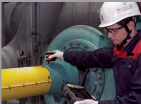
Измерение уровня вибрации Замер уровня вибрации позволяет оценить качество проведённой центровки.
